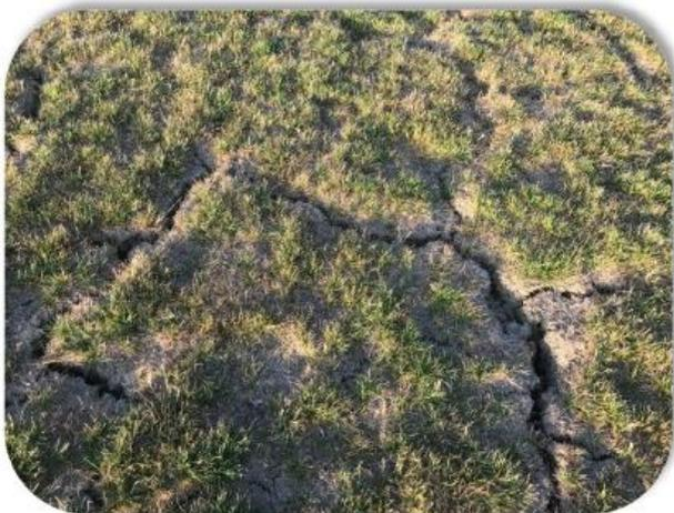
Figure 28 : exemple de retrait des argiles en période de sécheresse
