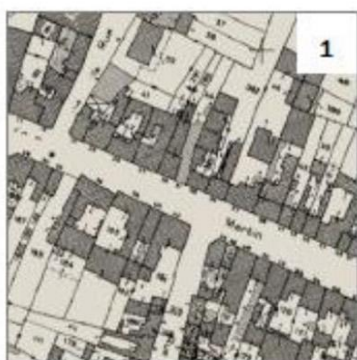
1 Rue Saint Martin : constructions mitoyennes à l'alignement
